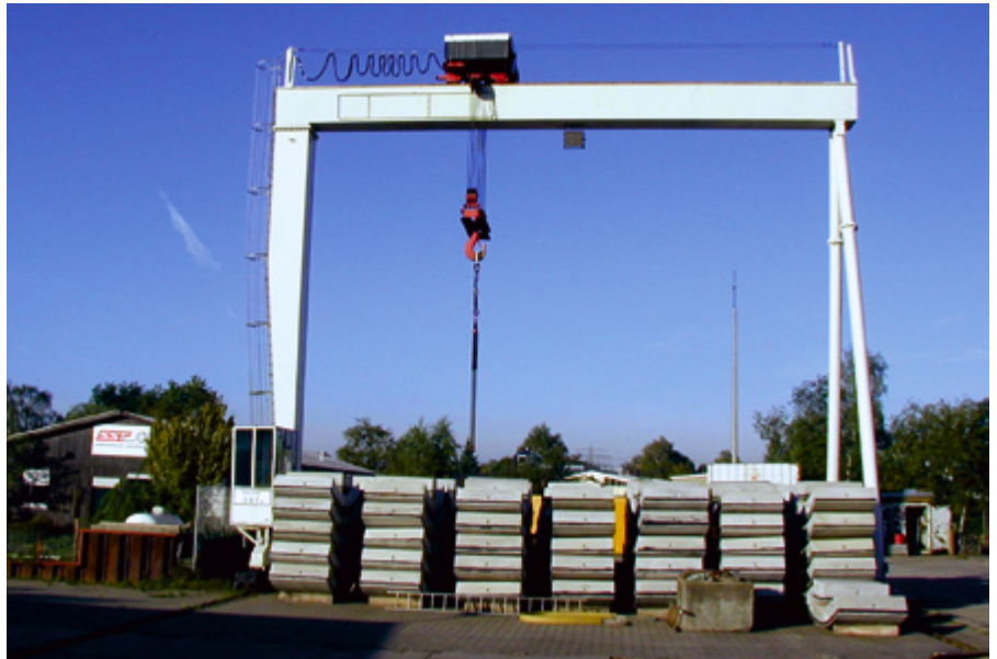
Der extra für dieses Projekt angeschaffte Portalkran mit einer Hubkraft von bis zu 45 Tonnen
